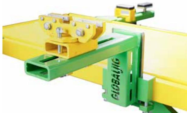
Con la ampia e veloce regolazione in altezza delle morsettiere è possibile ancorare qualsiasi tipo di veicolo con creste sottoporta dal minimo 89 mm ad un massimo di 308 mm ed è quindi possibile applicare ed utilizzare sul banco qualsiasi tipo di sistema di misurazione elettronico in commercio.
