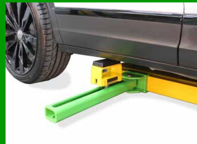
La regolazione e la scelta di altezza delle 4 morse, avviene con l'ausilio di una pistola ad aria che velocizza le operazioni di fissaggio della vettura ed un rapido smontaggio al termine delle operazioni di tiro.
