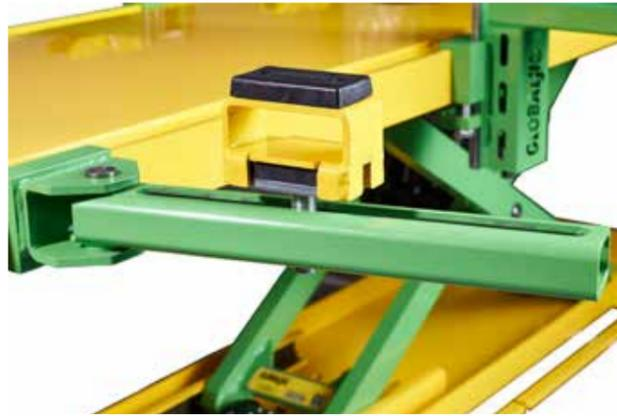
I braccetti orientabili restano sempre montati sul telaio anche quando si posiziona la vettura, sui quali si utilizzano i tamponi scorrevoli in gomma regolabili manualmente in altezza, e quelli sovrapponibili per sollevare veicoli con creste o pianali sottoporta più alti.
