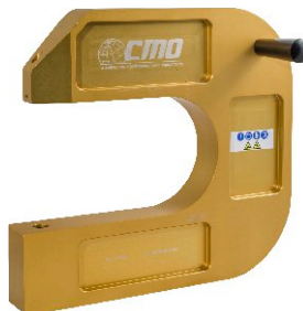
◀ Trancia 10 Ton idraulica per il taglio della lamiera. Utilizzabile per la foratura con punzoni da 0,6 mm e da 0,8 mm. Questo accessorio è necessario per la foratura della nuova lamiera in alluminio e per la calibratura dei fori esistenti delle lamiere in alluminio e in acciaio. Foratura della lamiera in acciaio al boron fino a 3 mm.
