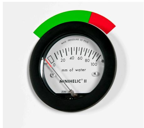
Strumentazione di controllo dell'efficienza della cartuccia filtrante
